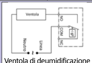
Ventola di deumidificazione
